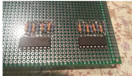
Abb. 11: Schieberegister mit Widerständen [7]
