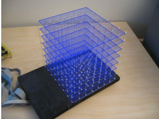
Abb. 4 Anode Ebenen am 8x8x8 LED Würfel
